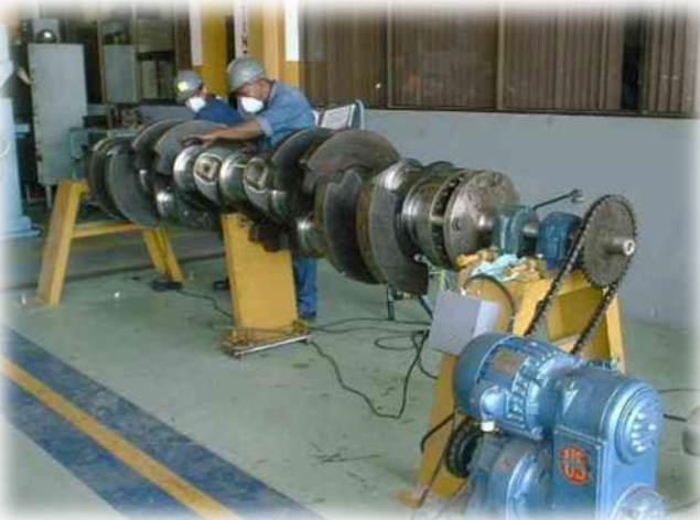
Midiendo los cojinetes del cigüeñal para un motor de velocidad mediana de Caterpillar®.
